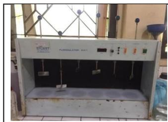
**Gambar 1.** Alat Jartest untuk
