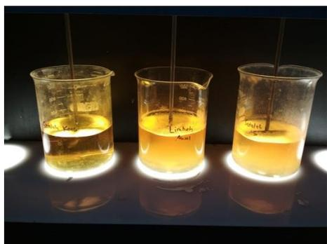
**Gambar 6.** Proses pengadukan menggunakan alat jartest dengan kecepatan 100 rpm untuk *rapid mixing* dan 50 rpm untuk *slow mixing*
